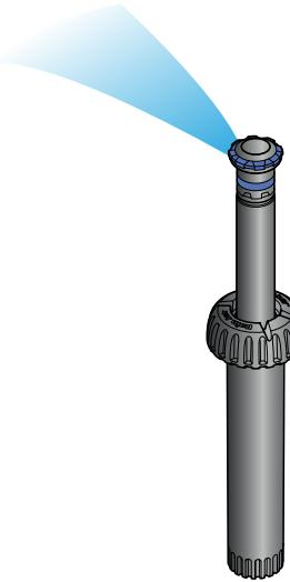
**IT VARIARE L'ANGOLO DI IRRIGAZIONE DA 80° A 360°.** Questa operazione serve ad aumentare o diminuire l'angolo di lavoro dell'irrigatore. Per scegliere l'angolo di lavoro tenere bloccata la parte inferiore della testina e l'asta, ruotare la ghiera blu posta sulla sommità della testina: ruotare in senso antiorario per aumentare l'angolo, in senso opposto per diminuirlo.
